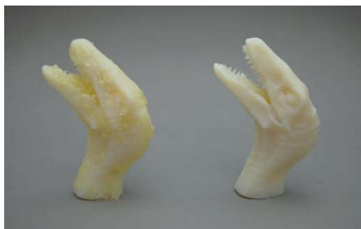
写真左：モデル造形後、サポート材を粗取りした状態
